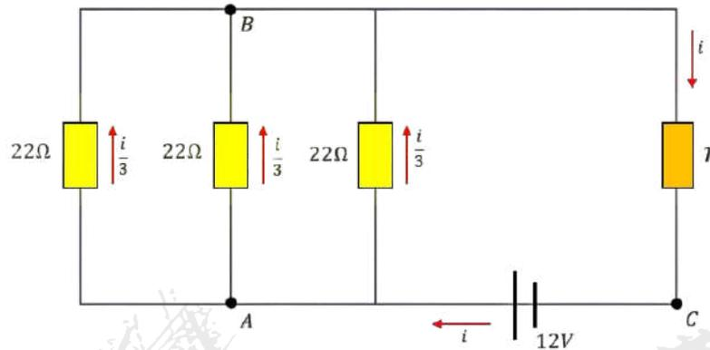
Se convencionamos o ponto A com potencial  $V_A = 0$ , o ponto B terá, conseqüentemente,  $V_B = -\frac{22i}{3}$  pela Lei de Ohm. Por conseqüência, no ponto C,  $V_C = -i(\frac{22}{3} + r)$ . Daí, obtemos nossa primeira equação:
