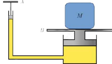
Sem a presença do bloco de massa  $M$  na plataforma  $B$ , o sistema está em equilíbrio. É necessário aplicar uma força vertical  $F=200N$  no pistão  $A$  para elevar o bloco apoiado na plataforma  $B$  com velocidade constante. Determine:
