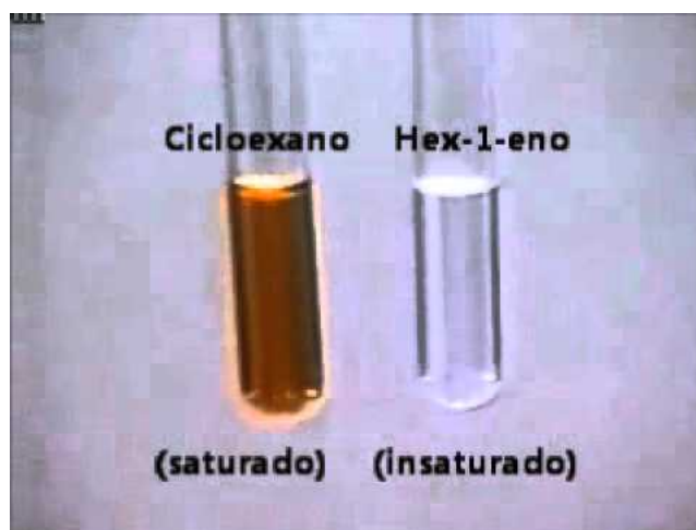
Figura 2: teste do bromo; esquerda: negativo; direita: positivo
