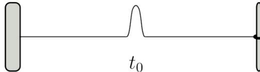
**Solução:** Primeiramente, após a perturbação, aparecerão duas ondas de mesma amplitude (metade da originária) e que se propagam em direções opostas. Esse fato já nos elimina os itens c), d) e e).
