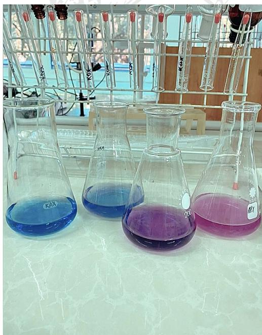
Figura 9: Da direita para a esquerda, houve progressiva adição da solução de EDTA.
