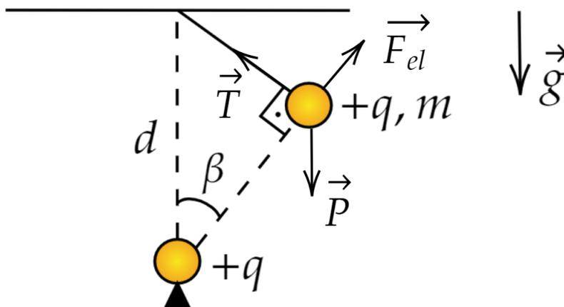
A carga sente a força elétrica, devido à interação com a outra carga, como sente também sua força peso e a força de tração no fio.
