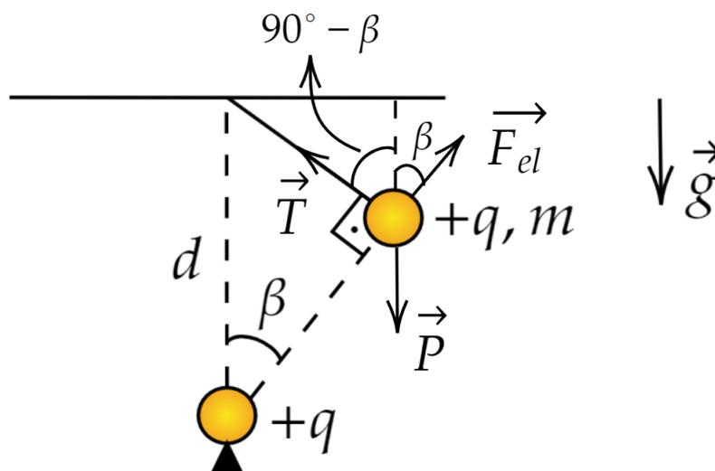
Podemos decompor as forças na horizontal e vertical, para então equilibrá-las, obtendo o seguinte sistema de equações:
