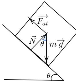
Podemos notar que a força de atrito está na direção do movimento, tentando freá-lo, e a normal está perpendicular ao movimento. Como o bloco não pode simplesmente saltar da rampa, a aceleração e, portanto, a força resultante na direção perpendicular ao movimento. Portanto, é interessante dividirmos a força peso em componentes na direção do movimento e perpendicular ao movimento. Conforme a geometria apresentada, podemos dividir a força de tal forma:
